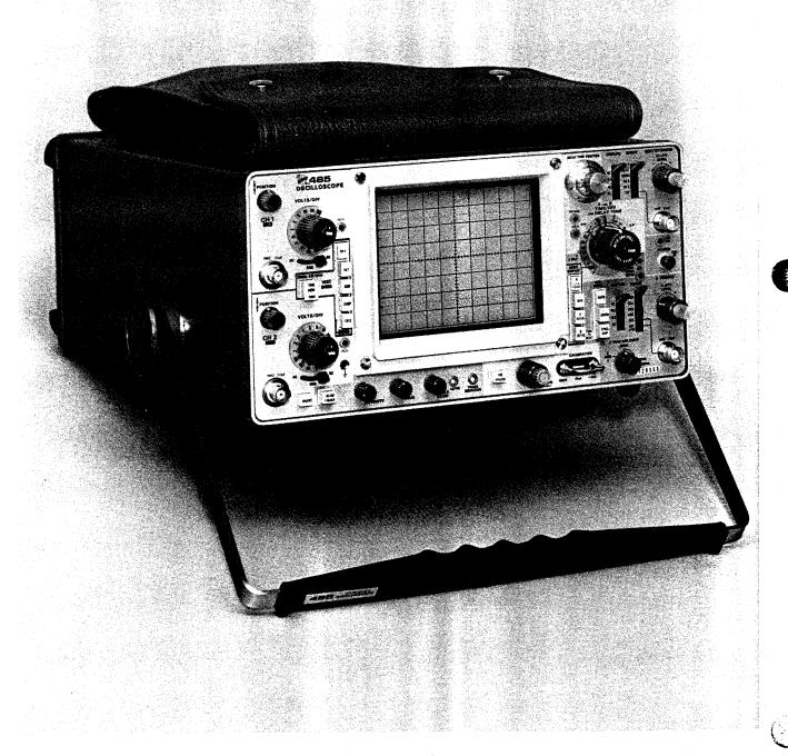
Fig. 1-1. 465 Oscilloscope.
